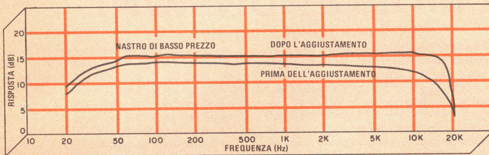
Fig. 3 - Un nastro di basso prezzo mostra limiti evidenti nelle sue prestazioni, ma dopo la sequenza di aggiustamento le sue prestazioni risultano decisamente migliorate.
